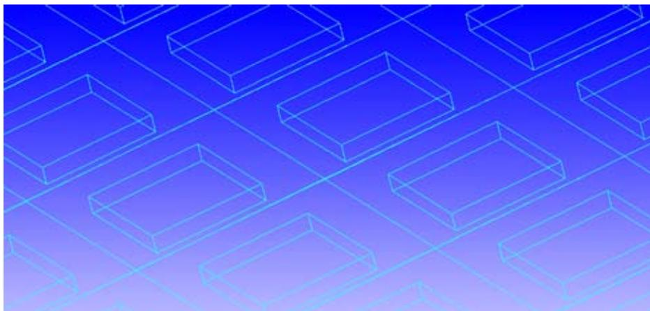
Рис. 6. Микроструктура световода, состоящая из отверстий прямоугольной формы
